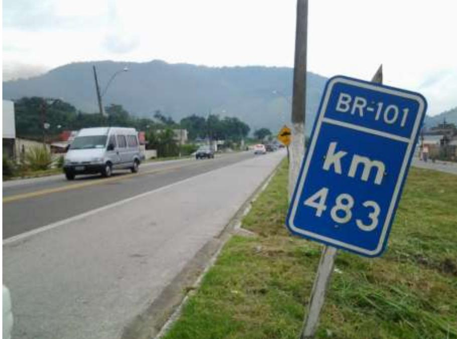
**Figura 89.** Marco quilométrico em desacordo com a inclinação correta das placas no km
