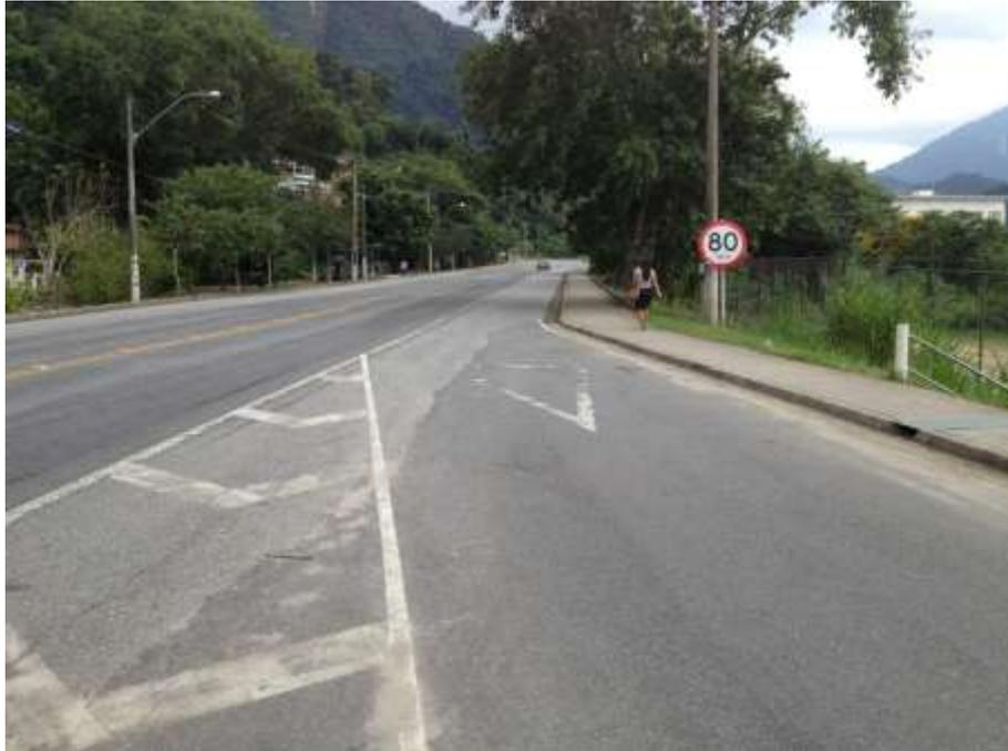
**Figura 121.** Marcas de canalização desgastadas no km 469
