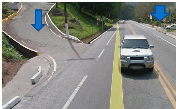
**Figura 47.** Acessos com conversão à esquerda e direita sem faixa de aceleração no km 473
